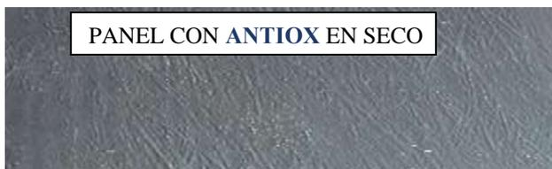
Después de transcurrido los 30 minutos después que se ha secado la aplicación, esta se tornara de color negro, confirmando que se ha llevado a cabo el proceso de conversión de la corrosión de la superficie metálica.
